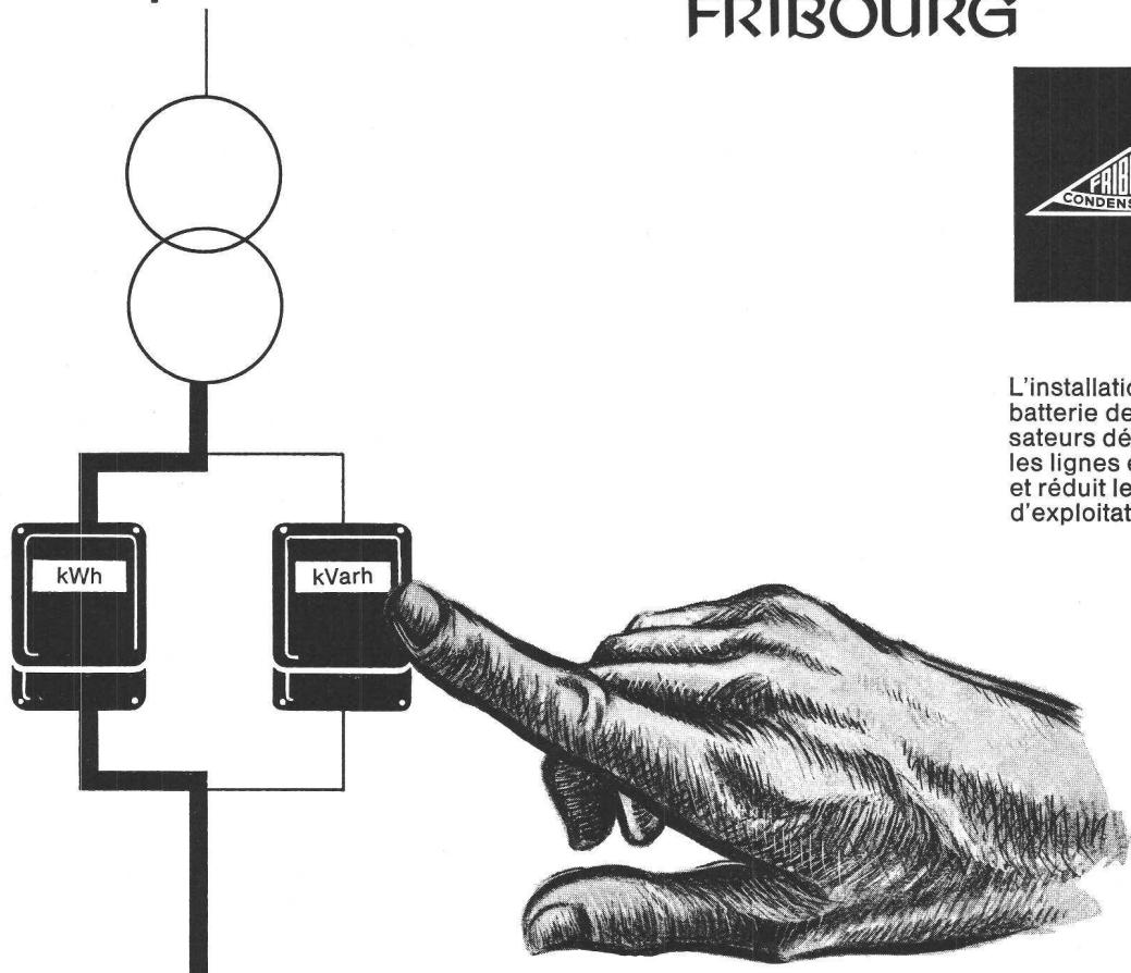
L'installation d'une batterie de condensateurs décharge les lignes électriques et réduit les frais d'exploitation ...
