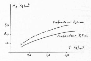
Fig. 7. — Variation des modules  $M_E$  avec la pression (essais œdométriques).
