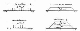
Fig. 1. — Charges transmises par les ouvrages et détails des remblais provisoires.
