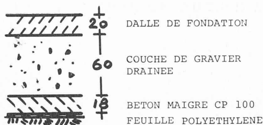
Fig. 3. — Détail de la fondation.
