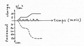
Fig. 5. — Diagramme tassement-temps.
