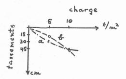
Fig. 6. — Diagramme charge-tassement (surface circulaire).
