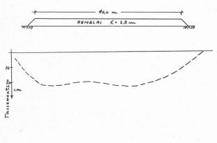
Fig. 4. — Profils des tassements.
