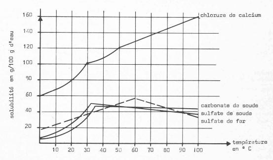
Fig. 2. — Variation de la solubilité dans l'eau de sels formant plusieurs hydrates, en fonction de la variation de la température de l'eau.
