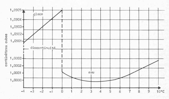
Fig. 1. — Variations du volume de la glace et de l'eau en fonction de la variation de la température.
