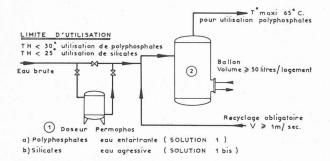
Fig. 6 a. — Dosage à polyphosphates et silicates par déplament.
