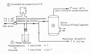
Fig. 6 b. — Dosage de polyphosphates et silicates par pompe doseuse.
