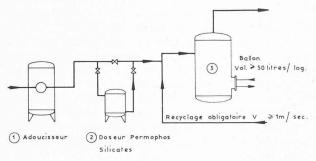
Fig. 6 c. — Traitement de l'eau par adoucisseur et doseur à déplacement.
