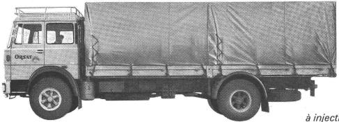
à injection directe, cycle 4 temps. 6 cylindres. Cylindrée: 13 798 cm<sup>3</sup>. Puissance: 260 CV-DIN. Poids total
