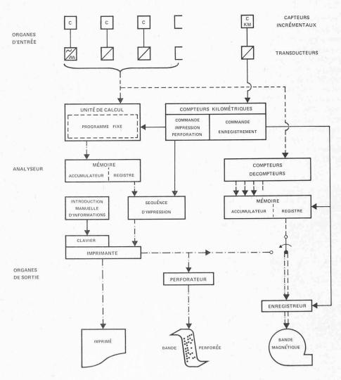
Fig. 3. — Schéma-bloc de fonctionnement de l'analyseur
