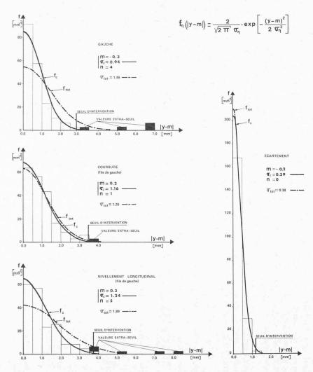
Fig. 6. — Analyse de l'état géométrique à partir des valeurs discrètes.
