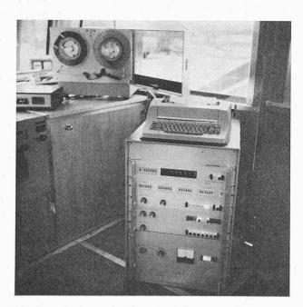
Fig. 2. — Analyseur de l'état géométrique des voies.
