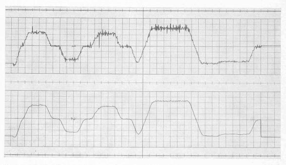
Fig. 4. — Effet d'un filtre « passe-bas » ; signal de la courbure non filtré et filtré.
