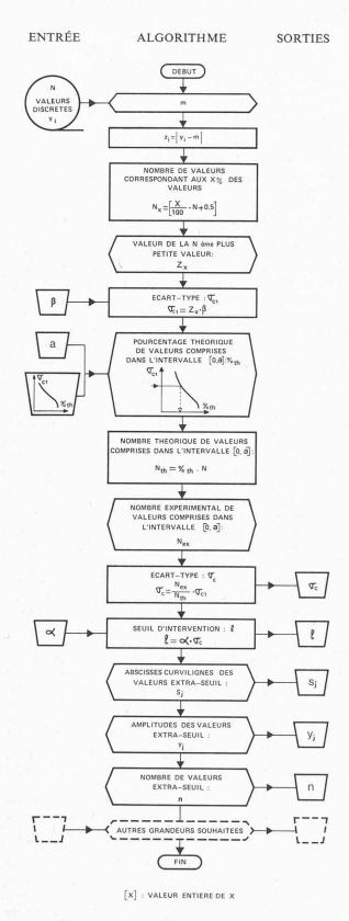
Fig. 5. — Algorithme d'analyse de l'état géométrique à partir des valeurs discrètes.
