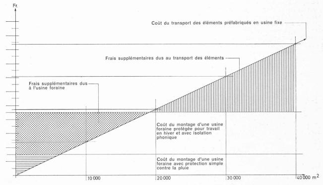
Fig. 1. — Comparaison des frais d'installation d'une fabrique foraine munie d'une simple toiture pour la protéger des intempéries, d'une fabrique foraine insonorisée et équipée pour travailler
