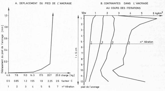
Fig. 10. — Calcul par la méthode des éléments finis.
