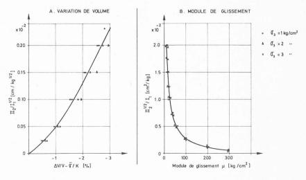
Fig. 4. — Lois contrainte-déformation pour un sable compact ( $\gamma = 2.07 \text{ t/m}^3$ , w = 26 %,  $\varphi = 37^\circ$ ).
