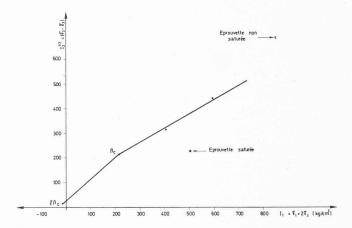
Fig. 7. — Courbe de rupture pour un grès.
