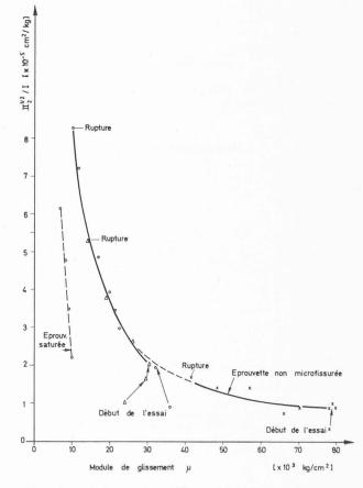
Fig. 8. — Loi contrainte-déformation pour un grès.
