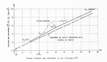
Fig. 3. — Courbe de rupture pour un sable compact.
