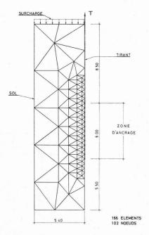
Fig. 9. — Réseau des éléments finis.
