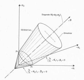
Fig. 4. — Surface tronconique de rupture du béton.
