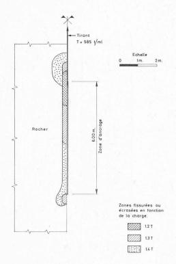
Fig. 22. — Zones fissurées ou écrasées en fonction de la force du tirant.
