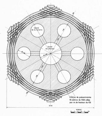
Fig. 10. — Caisson du réacteur rapide.
