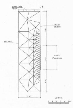
Fig. 20. — Tirant d'ancrage. Réseau des éléments finis.
