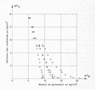
Fig. 7. — Variation du module de glissement  $\mu$  en fonction du déviateur des contraintes  $I_2$  [4].
