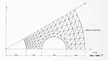
Fig. 11. — Caisson. Réseau des éléments finis.
