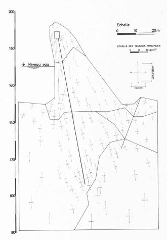
Fig. 19. — Barrage. Tensions principales. Lac vide.
