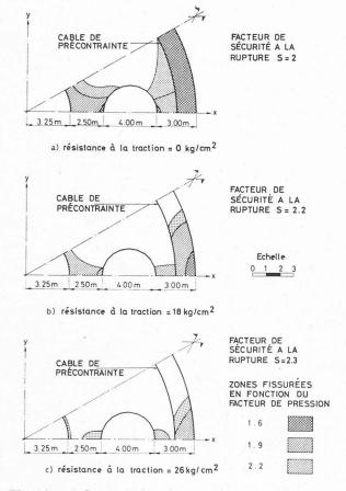
Fig. 16. — Influence de la résistance à la traction du béton sur la fissuration et la rupture du fût.
