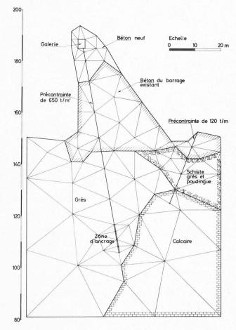
Fig. 17. — Barrage. Réseau des éléments finis.
