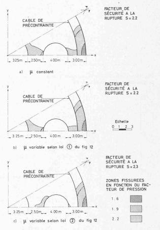
Fig. 15. — Influence de la loi de variation de  $\mu$  sur la fissuration et la rupture du fût.
