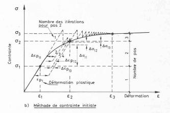
Fig. 9. — Processus de calcul non linéaire par les méthodes de déformation et de contrainte initiale.
