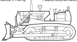
BD18 Largeur lame: 3,45 m Hauteur lame: 1,30 m Puissance: 180 CV DIN Poids en ordre de marche: 18'900 kg
