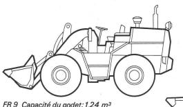
FR 9 Capacité du godet: 1,24 m³ Puissance: 88 CV DIN Poids en ordre de marche: 8'000 kg
