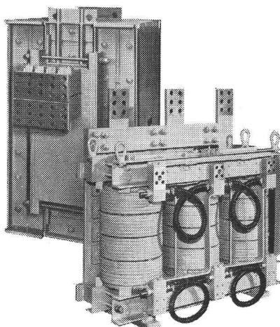
Transformateur pour machine à souder par résistance, 560 kVA/7,2 Hz, pour une usine de wagon en métal léger.
