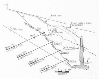
Fig. 6. — Consolidation après éboulement, km 24,830.
