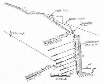
Fig. 5. — Murs avec ancrages, km 24,710 — 25,052.
