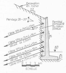
Fig. 4. — Ancrages du soutènement à Nant.
