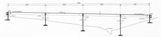
Fig. 3. — Coupe longitudinale du pont amont.
