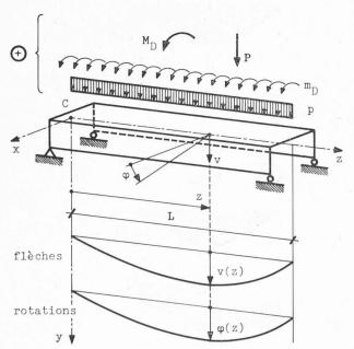
Fig. 4. — Déformée d'une poutre.
