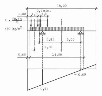
Fig. 15. — Répartition transversale des charges en travée.
