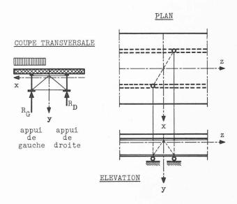
Fig. 12. — Réactions sur les appareils d'appui.
