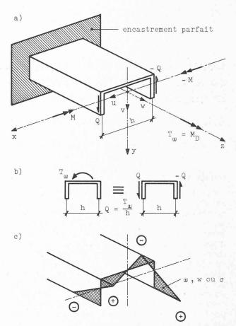
Fig. 3. — Gauchissement d'un profil soumis à un moment de torsion.
