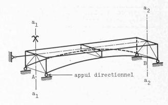
Fig. 10. — Conditions d'appuis d'une travée simple, non prismatique.
