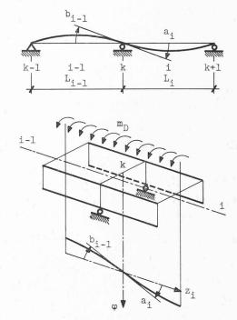
Fig. 6. — Compatibilité des déformations sur appuis des poutres continues.
