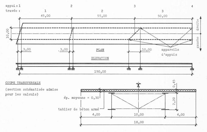
Fig. 13. — Exemple d'un pont-biais à trois travées : caractéristiques géométriques.
