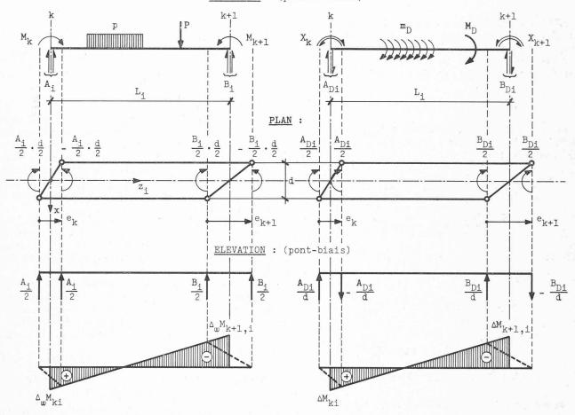
Fig. 8. — Statique du pont-biais : interaction flexion-torsion.
