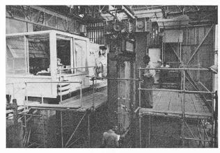
Fig. 4. — Presse de 900 tonnes pour essai des murs.
