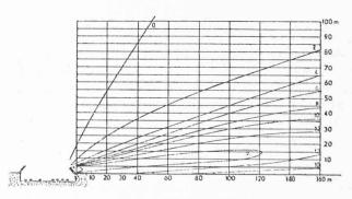
Fig. 2. — Réduction du bruit obtenue au voisinage d'une autoroute en tranchée par deux écrans inclinés munis d'absorbants.
