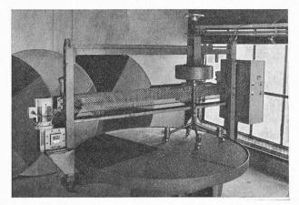
Fig. 5. - Machine d'essai des revêtements de sol.
