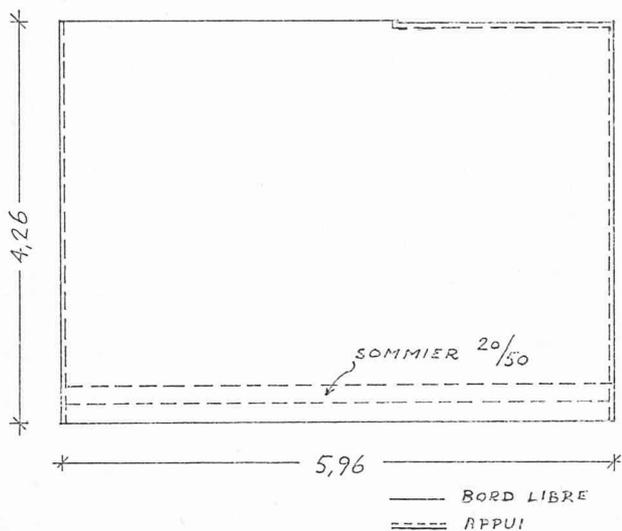
Fig. 5. — Dimensions et conditions d'appui d'une dalle préfabriquée.
