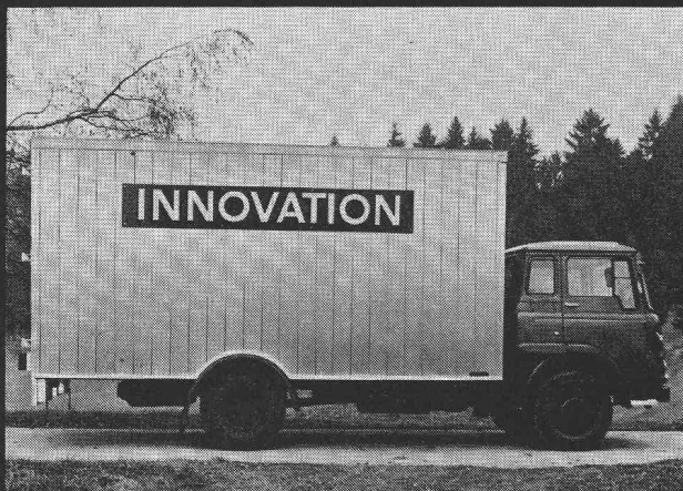
Superstructure robuste d'un fourgon en profilés aluminium
