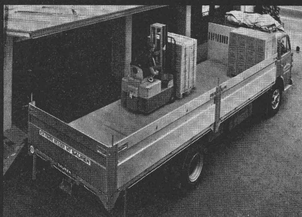
Pont tout aluminium pouvant supporter les chariots élévateurs
