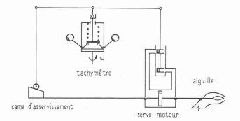
Fig. 6. — Schéma du régulateur tachymétrique.
