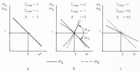
Fig. 1. — Couples moteur  $(m_t)$  et de charge  $(m_e)$  en fonction de la vitesse pour diverses turbines et charges :
