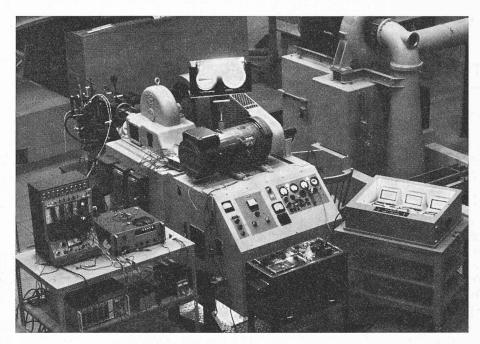
Fig. 2. — Modèle turbine-générateur de l'installation d'essais.
