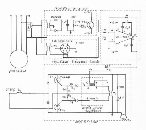
Fig. 9. — Circuit de l'asservissement fréquence-tension.
