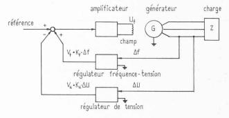
Fig. 8. — Schéma de principe de l'asservissement fréquencetension.
