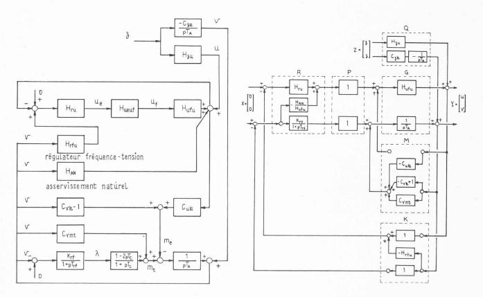
Fig. 10. — Diagramme fonctionnel du réglage combiné de la fréquence et de la tension.
