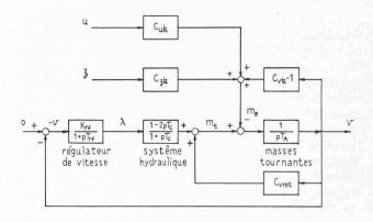
Fig. 5. — Diagramme fonctionnel du réglage de vitesse.
