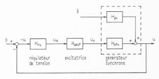
Fig. 7. — Diagramme fonctionnel du réglage de tension.
