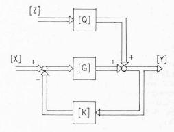
Fig. 4. — Représentation symbolique d'un système multivariable en boucle fermée.
