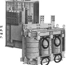
Transformateur pour machine à souder par résistance, 560 kVA/7,2 Hz, pour une usine de wagon en métal léger.
