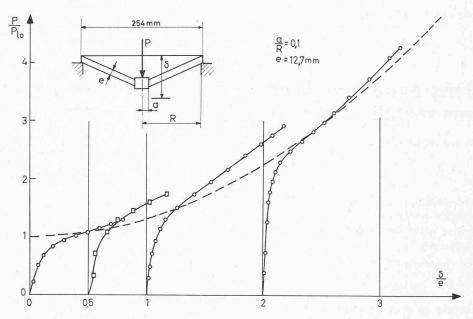
Fig. 1. — Coques coniques tendues sous charge axiale concentrée.
