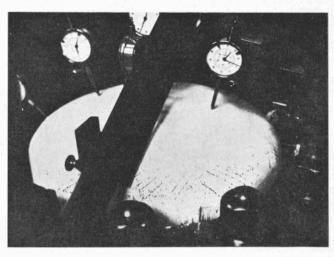
Fig. 9. — Essai jusqu'à ruine plastique d'un réservoir tori-sphérique : lignes de glissement.
