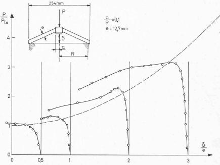
Fig. 2. — Coques coniques comprimées sous charge axiale concentrée.
