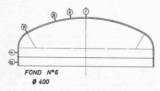
flèche-charge typiques et des déformées plastiques de ces fonds de réservoirs sont donnés aux figures 7 et 8. Le mécanisme de ruine plastique prévu s'est effectivement réalisé, sans être influencé de manière appréciable par les changements de forme.
