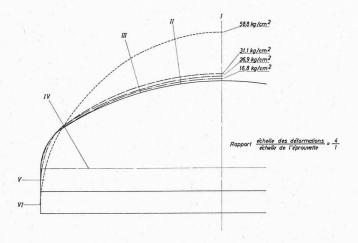
Fig. 8. — Essai jusqu'à ruine plastique d'un réservoir torisphérique : déformées.
