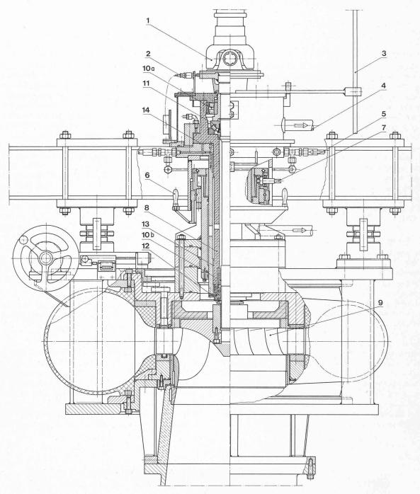
Fig. 4. — Machine hydraulique d'essai
