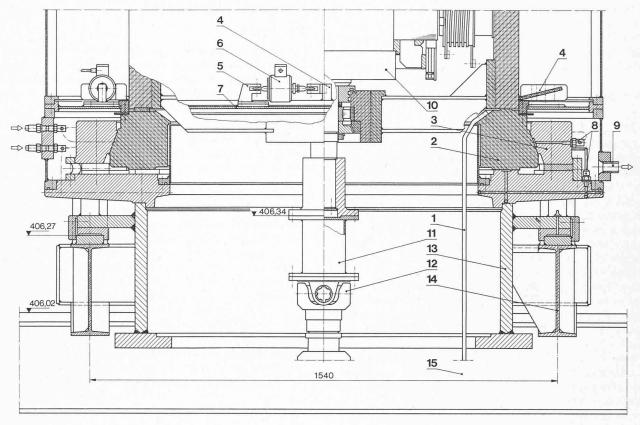
Fig. 5. - Pivot hydrostatique
