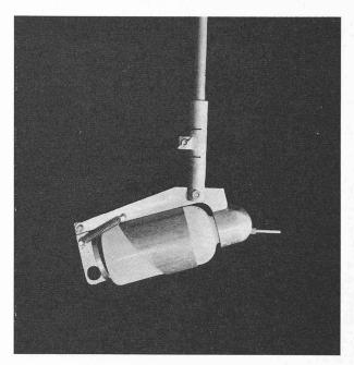
Fig. 7. — Sonde AW-3 pour prélèvements par intégration verticale.
