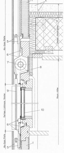
Fig. 1. — Coupe verticale d'une fenêtre échelle 1:6.
