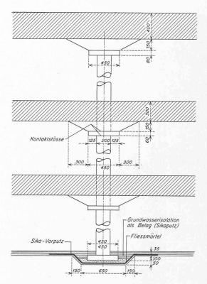
Fig. 9. — Détail des colonnes en acier dans les trois sous-sols.
