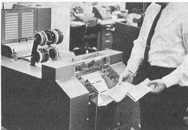
Fig. 8. — Machine pour renforcer l'œillet et appliquer un trait de couleur.
