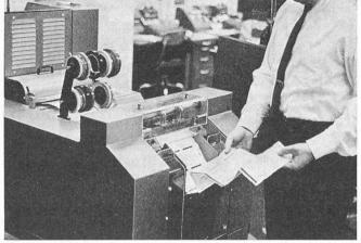
Fig. 8. — Machine pour renforcer l'œillet et appliquer un trait de couleur.
