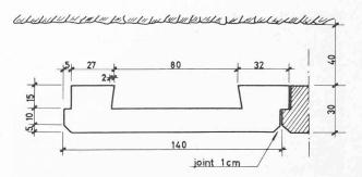
Fig. 5. — Détail de l'assemblage des plaques.
