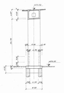
Fig. 5. — Elévation de la palée 2.
