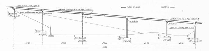
Fig. 1. — Coupe longitudinale développée du pont.
