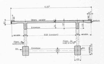
Fig. 4. — Coupe du tablier sur l'arc.
