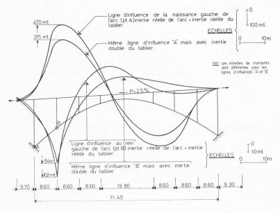
Fig. 5. — Lignes d'influence des moments fléchissants à la naissance et aux reins de l'arc du pont aval.
