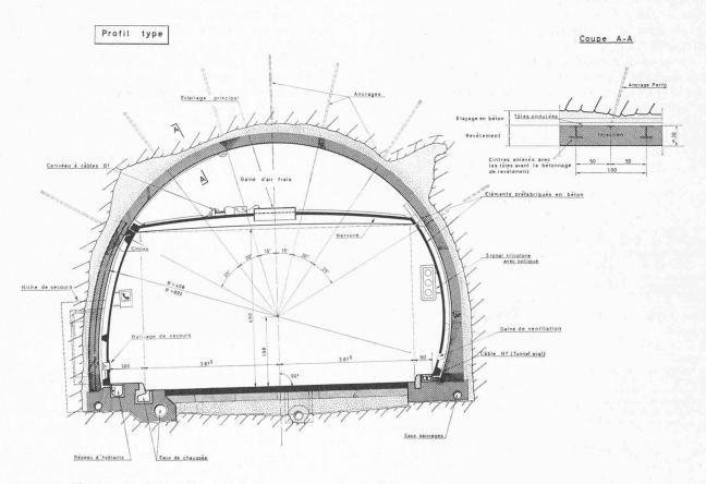
Fig. 2. — Profil type d'un tunnel
