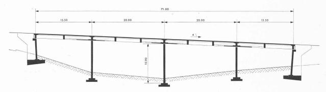
Fig. 8. — Pont du Cabinet, coupe longitudinale.
