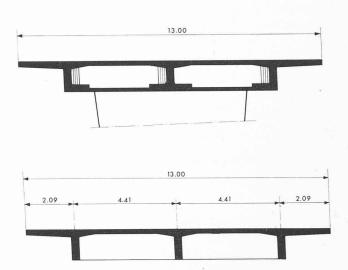
Fig. 7. — Pont du Cabinet, coupes sur appui et en travée.
