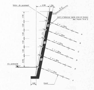
Fig. 2. — Mur ancré, coupe verticale au droit d'un pilier.
