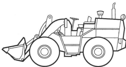
FR 9 Puissance: 88 CV DIN Poids total: 8'000 kg
