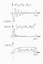
Fig. 7. — Paramètres :  $K_f = 0.6$  ;  $K_f = 2$  ; R = 0.16 (à comparer avec la figure 5). Influence de l'action P
