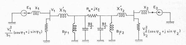
Fig. 1. — Schéma électrique équivalent de l'ensemble.
