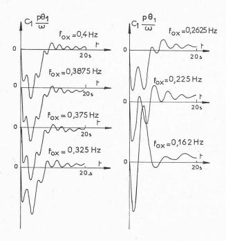
Fig. 25. — Variation des fréquences d'oscillations (déduites des courbes 17 à 24).
