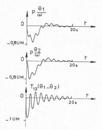
Fig. 4. — Courbes de réponse des variations de fréquence et puissance échangée.
