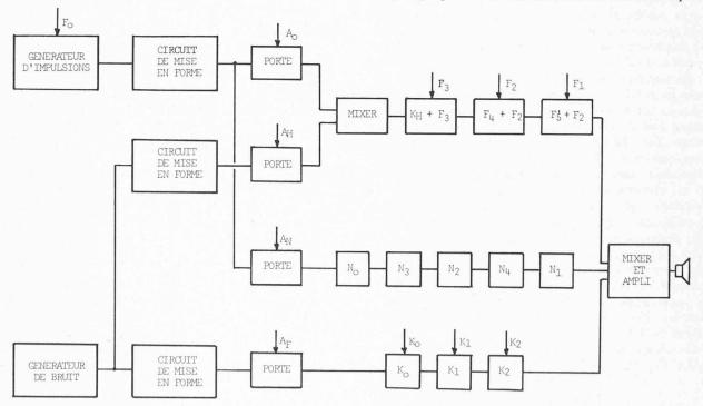
Fig. 13. — Schéma de principe de OVE II.
