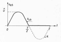
Fig. 2.1. — Montage à une seule diode. Charge résistive.  $u^{ch} = f(t)$ .
