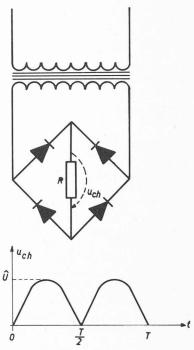
Fig. 2.2.2. — Montage en pont monophasé. Charge résistive.  $u_{ch}=f\left(t\right)$ .
