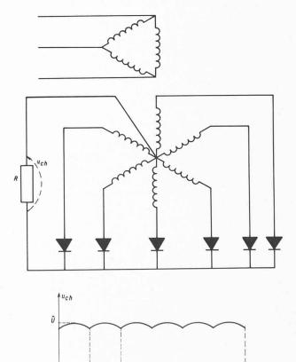
Fig. 2.4. — Montage trihexaphasé. Charge résistive.  $u_{ch} = f(t)$ .
