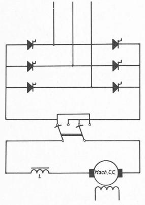
Fig. 3.1.5. — Freinage d'une machine à courant continu avec récupération en ayant la possibilité d'inverser la tension d'induit.
