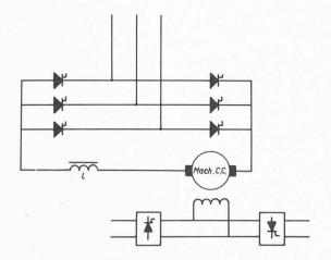
Fig. 3.1.6. — Freinage d'une machine à courant continu avec récupération en ayant la possibilité de croiser l'excitation.
