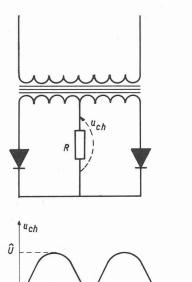
Fig. 2.2.1. — Montage avec transformateur à point milieu. Charge résistive.  $u_{\it ch}=f(t)$ .
