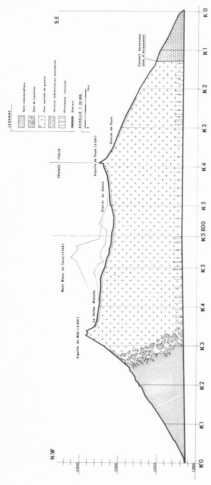
Fig. 2. — Tunnel du Mont-Blanc : coupe géologique succincte, schématisée.
