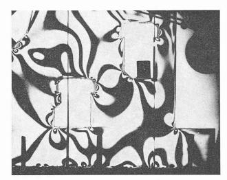
Cas de charge  $G_1 + P + W$ ,  $E_1 : E_2 : E_3 = 1 : \frac{1}{2} : \frac{1}{6} \mu = 1,0$ , Isochromes demi-ordres (polaroïdes parallèles, polarisation circulaire). Définition du cliché selon figure 12. On notera l'effet de bord dû au vieillissement ainsi que la diminution des contraintes au point  $I_7$ .
