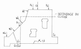
Fig. 12. — Position des clichés dans le cas de charge  $G_1 + P + W$ ,  $E_1 : E_2 : E_3 = 1 : \frac{1}{2} : \frac{1}{6}$ ,  $\mu = 1,0$ .
