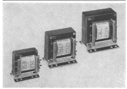
Les transformateurs du type ETP de 5-85 VA sont conçus pour être soudés directement sur les circuits imprimés. Sauf le type ETP 3, ils sont munis d'entretoises. Les enroulements primaire et secondaire sont séparés. Le type ETO est une autre exécution, équipé de cosses à souder ou d'extrémités de fils libres et qui peut être livré également avec des fiches AMP. D'autres constructions sur demande.
