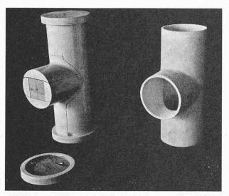
Fig. 7. — Moule en bois et branchement en amiante-ciment (90 / 1 / 0,1).
