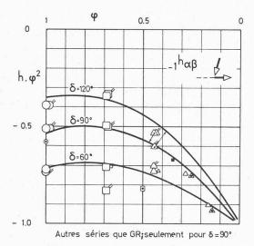
Fig. 34. — Différence de charge  $_{-1}h_{\alpha\beta}$ , en fonction de  $\varphi$ , pour écoulement provenant entièrement de la dérivation  $q_{\beta}=-1$   $(q_{\alpha}=0)$ .
