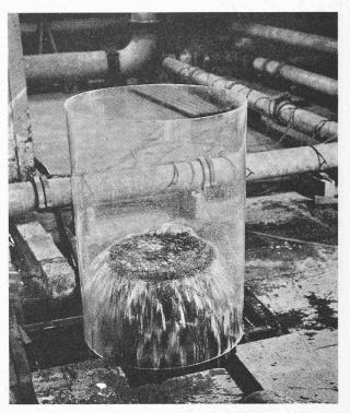
Fig. 5. — Dispositif de tranquillisation à l'exutoire.
