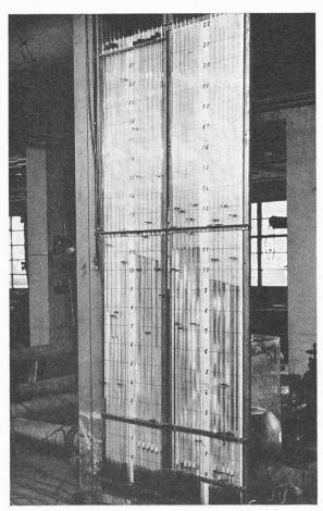
Fig. 4. — Tableau des tubes piézométriques.
