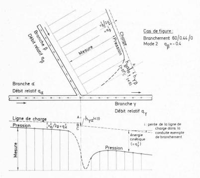
Fig. 10. - Pression et charge le long de l'écoulement.
