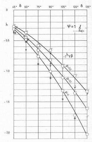
Fig. 31. — Perte de charge  $-_1 h_{\gamma\beta}$  pour écoulement provenant entièrement de la dérivation  $q_{\beta}=-1$  ( $q_{\alpha}=0$ ).
