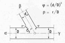
Fig. 6. — Définition de la forme du branchement.
