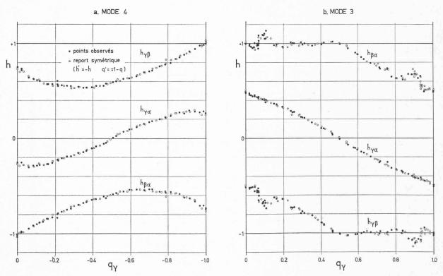
Fig. 17. — Comparaisons de cas symétriques d'écoulement dans le branchement « normal » (90 / 1 / 0).
