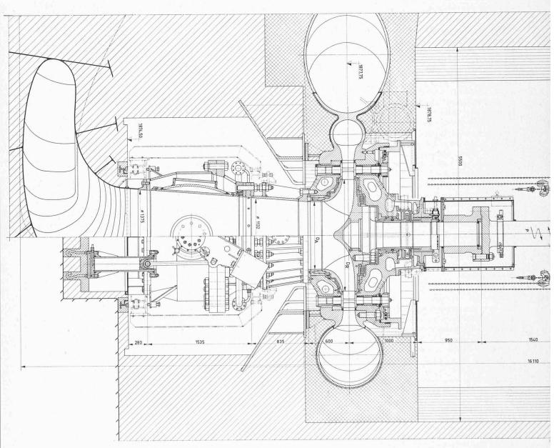
Fig. 8. — Groupe réversible 45 MVA - 1'000 t/min avec vanne sphérique haute pression, section verticale 1 : 40.
