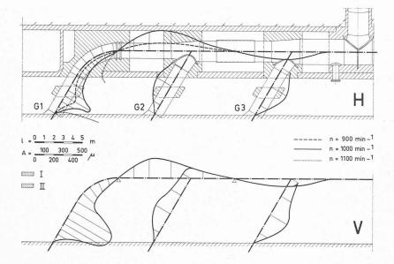
Fig. 15. — Collecteur basse pression : vibrations engendrées par le groupe nº 1 fonctionnant en turbine, en marche à vide, avant le bétonnage partiel de cet ouvrage.
