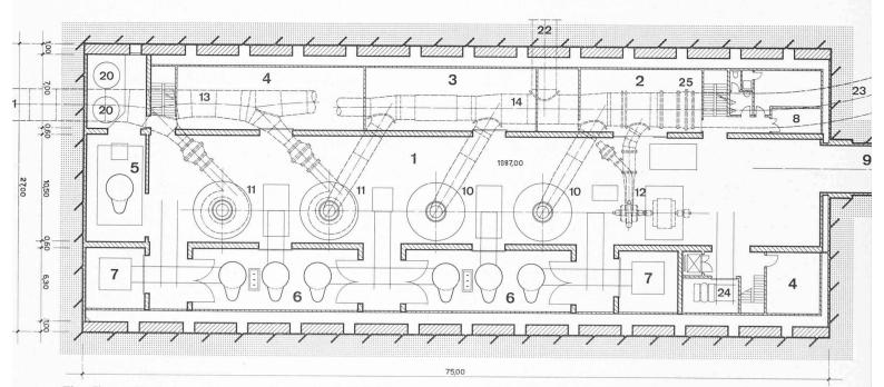
Fig. 7b. — Centrale souterraine existante de Robiei (selon variante B du projet), vue en plan 1 : 400.
