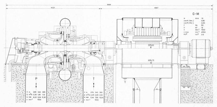
Fig. 9. — Groupe « Isogyre » 10 MVA — 1500 t/min. Section longitudinale 1:40.
