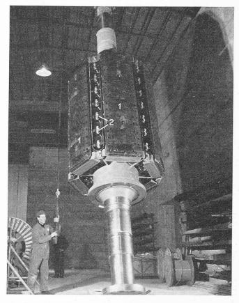
Fig. 12. — Rotor d'un moteur-générateur synchrone 45 MVA — 1000 t/min.
