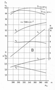
Fig. 17. — Courbes caractéristiques de fonctionnement, selon garantie des fournisseurs.
