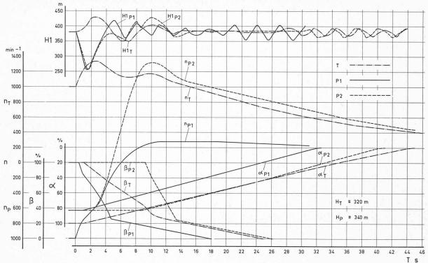
Fig. 16. — Décharges effectuées avec un seul groupe réversible fonctionnant en turbine, puis en pompe.
