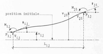
Fig. 3. — Déformée et sollicitation d'une barre ij dans la position déplacée du cadre.
