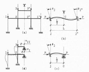
Fig. 13. — Flambage antimétrique d'un cadre dont l'axe de symétrie passe par le milieu d'une travée.
