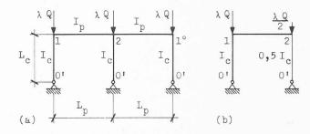
Fig. 20. — Cadre à deux panneaux étudié dans l'exemple 3.
