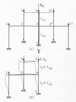
Fig. 15. — Flambage antimétrique d'un cadre dont l'axe de symétrie coïncide avec l'axe d'une colonne.
