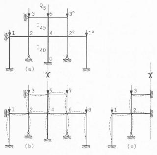
Fig. 17. — Flambage antimétrique et symétrique d'un cadre dont les déplacements des nœuds sont empêchés et dont l'axe de symétrie coïncide avec l'axe d'une colonne.
