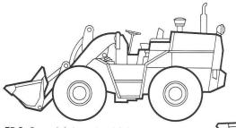
FR 9 Capacité du godet:1,24 m³ Puissance: 88 CV DIN Poids en ordre de marche: 8'000 kg
