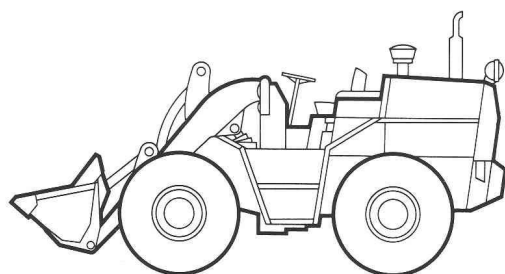
FR 9 Capacité du godet: 1,24 m 3 Puissance: 88 CV DIN Poids en ordre de marche: 8'000 kg
