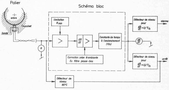
Fig. 2. — Schéma bloc du gradmètre
