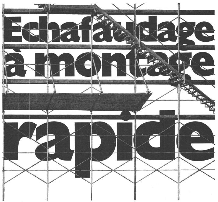
Vous connaissez l'échafaudage à montage rapide système Conrad Kern. Les cadres ont une largeur de 65 cm et un écartement de 2,50 m. Le platelage est réalisé par un plateau incorporé imprégné de 35 mm d'épaisseur. Il remplit également la fonction d'entretoisement horizontal et remplace de ce fait les entretoises horizontales.
