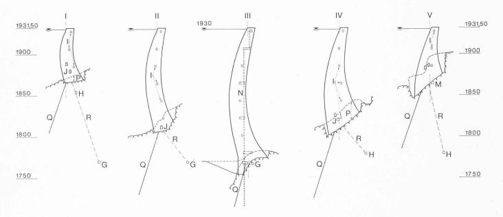
Fig. 12 — Coupes transversales du barrage.
