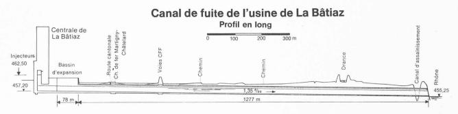
Fig. 18 — Profil en long et profil-type du canal de fuite de La Bâtiaz.
