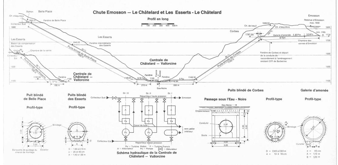
Fig. 13 — Chutes Emosson-Le Châtelard et Les Esserts-Le Châtelard ainsi que le puits blindé de Belle-Place. Profils en long, profils-types et schéma hydraulique de l'usine de Châtelard-Vallorcine.
