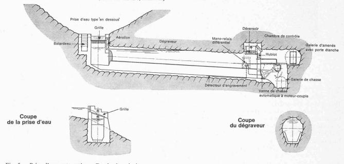
Fig. 5 — Prise d'eau automatique. Dessin de principe.
