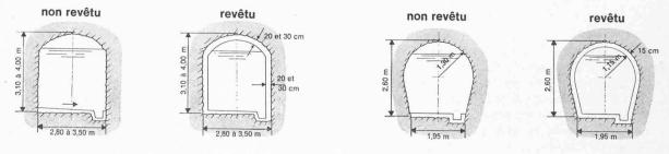
Fig. 6 — Profils-types des adductions.
