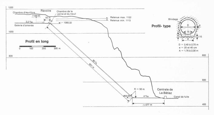
Fig. 16 - Profil en long et profil-type du puits blindé de Ravoire.
