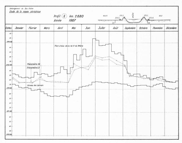
Fig. 6. — Variation du plan d'eau du Rhône et de la nappe aquifère au pied des digues (profil  $S \times 2.680$  - Année hydrologique 1967).
