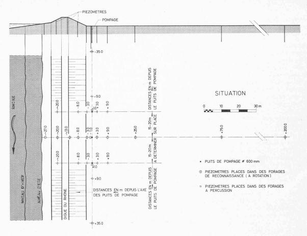
Fig. 10. — Essai de pompage d'Yvorne et de Port-Valais. Situation et profil en travers.
