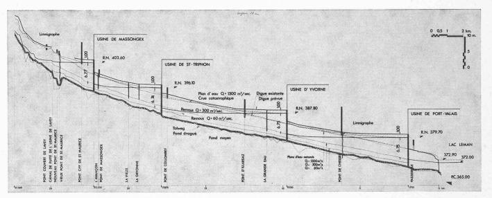
Fig. 2. — Profil en long du Rhône avec indication des usines prévues.
