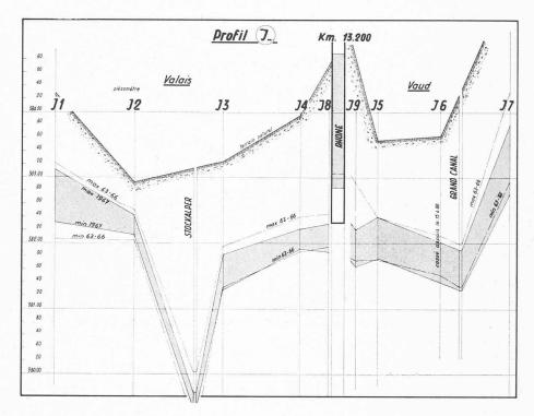
Fig. 5. — Profil d'observation à l'amont d'Yvorne (profil J km 13.230 - Année hydrologique 1967).
