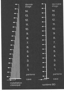
Comparaison entre l'installation classique (figure de gauche) avec un câble séparé pour chaque étage et la distribution par système BD (figure de droite).
