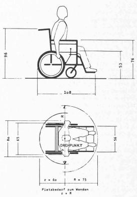
Fig. 6. — Dimensions d'un fauteuil roulant moyen. Surface minimale nécessaire pour une rotation de  $90^\circ$ :  $130\times130$  cm (NF 1.54).
