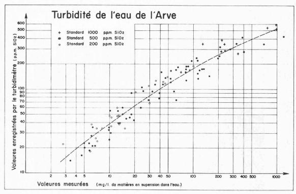
Fig. 9. — Station expérimentale de Vessy : Courbe de l'étalonnage du turbidimètre Sigrist pour l'eau de l'Arve.
