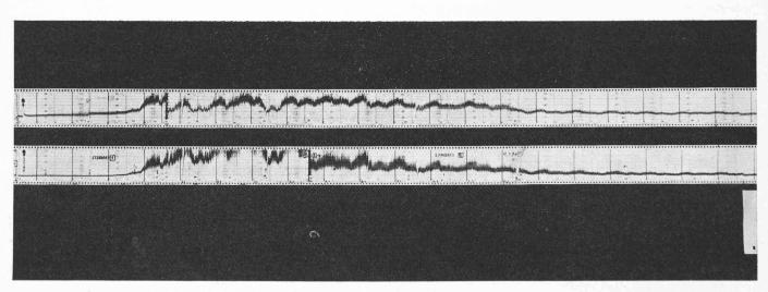
Fig. 12. — Enregistrement pendant 21 jours des traces de fluorescéine détectées par les appareils Sigrist.
