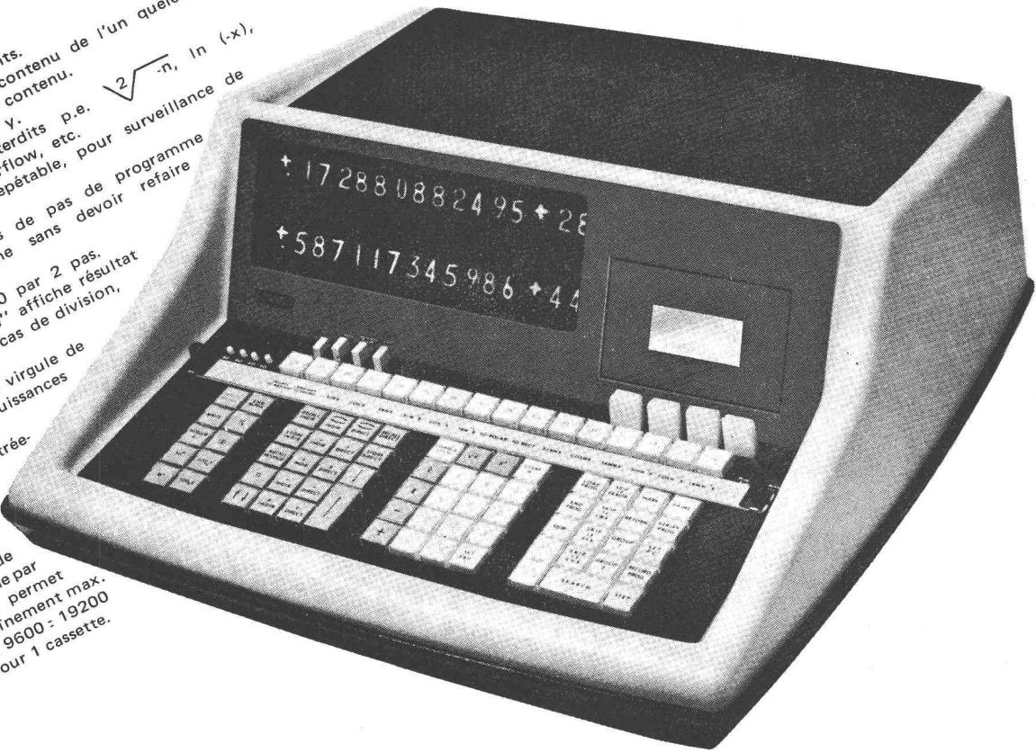
Registre opérateur avec Read Only Memorie de 40 K bits. Registre à mémoire d'une capacité de 8192 bits permettant 960 pas de programme ou 120 registres de travail. Affichage double avec tubes NIXIE : 12 chiffres, point décimal flottant, signe automatique, exposant de 2 chiffres (-99 à +99).
