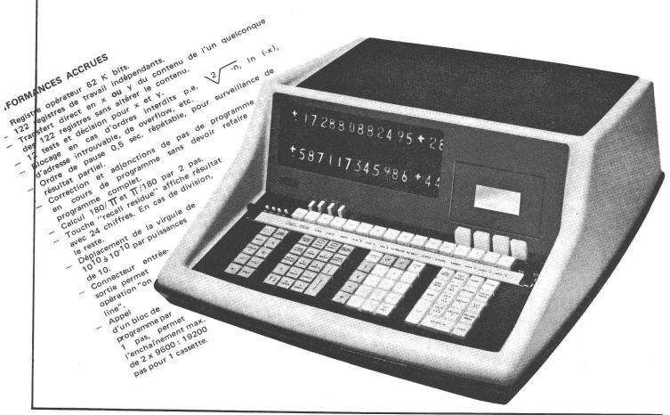
Registre opérateur avec Read Only Memorie de 40 K bits. Registre à mémoire d'une capacité de 8192 bits permettant 960 pas de programme ou 120 registres de travail. Affichage double avec tubes NIXIE: 12 chiffres, point décimal flottant, signe automatique, exposant de 2 chiffres (-98 à +99).
