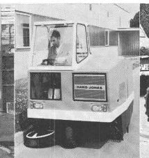
Hako-Jonas 1400 Machine à balayer et ramasser les ordures, hydraulique, pour l'industrie et le service de voirie. 10 000 m<sup>2</sup>/h. Hako-Jonas 1600 - 14 000 m<sup>2</sup>/h. Hako-Trac avec balayeuseramasseuse de front avec dispositif hydraulique de relevée. 120 cm de large. 8 000 m<sup>2</sup>/h. Convient très bien pour tous les travaux alentours de la fabrique.
